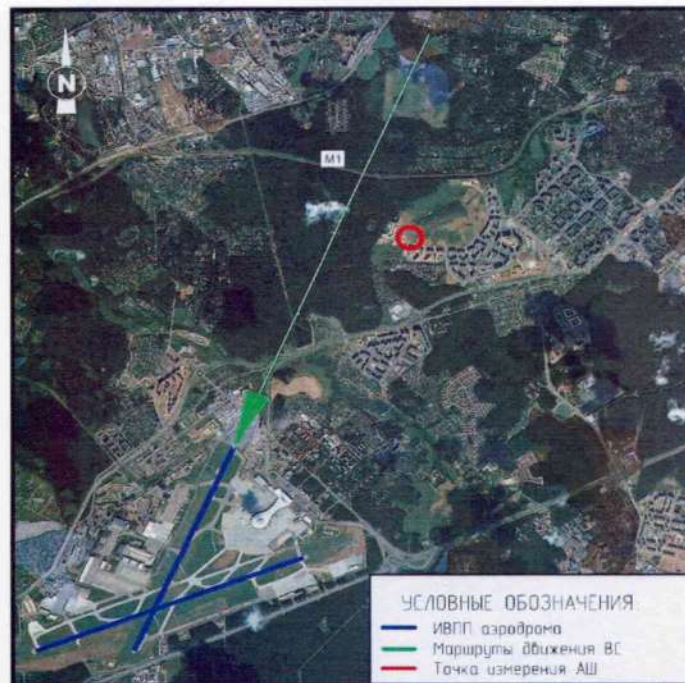
Рис. 6. Схема расположения точки (места) измерения относительно маршрута посадки с MK=193^\circ аэродрома
